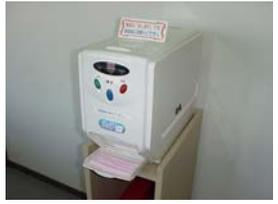
5. 次に水タンクを取り出し、底側のキャップを緩めて取り、水(2L)と洗浄液(10cc)を一緒に入れてください。水の補給を行なった水タンクを元の様にキャップが下向きになるようにセットしてください。
