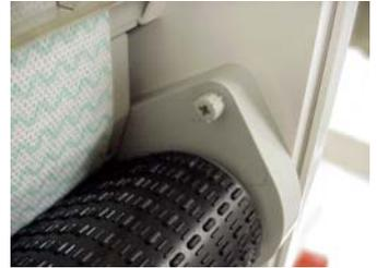
4、カセットローラーをゆっくりと手前に引き出してください。その際、水用ホースがつながっていますので、カセットローラーからねじりながら引きぬいてください。その水用ホースが下を向かないように、透明パネルの間に挟んでおいてください。
